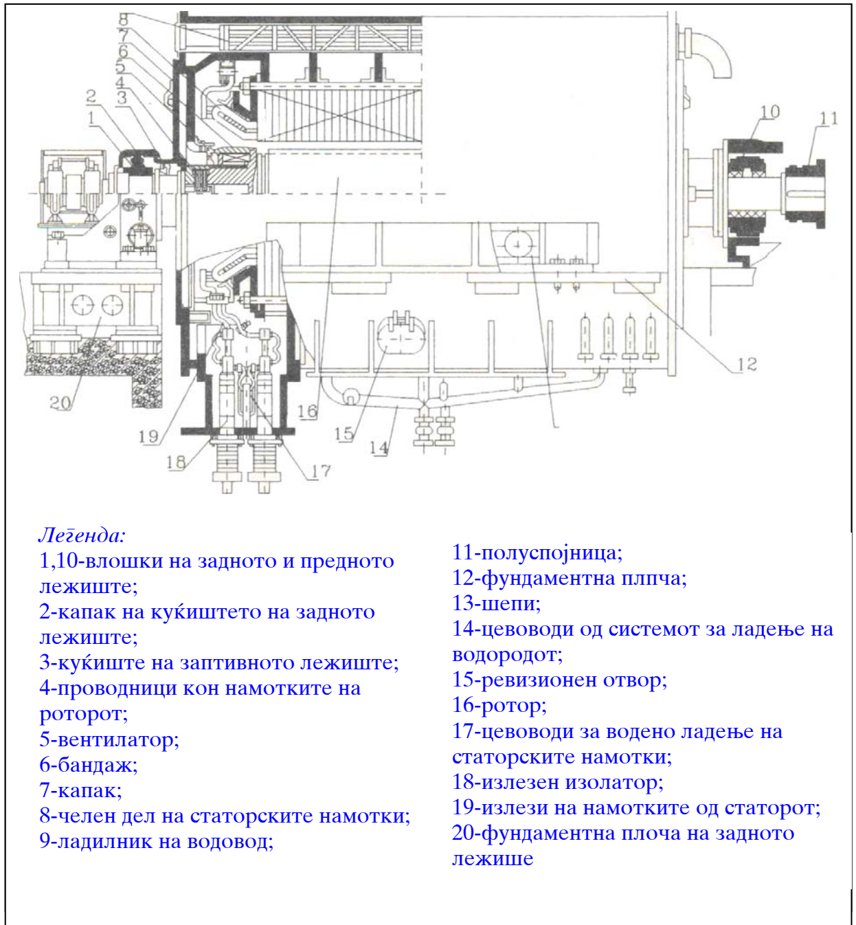
Слика бр. П-24: Составни делови на генераторот ТВВ-200-2АУЗ
