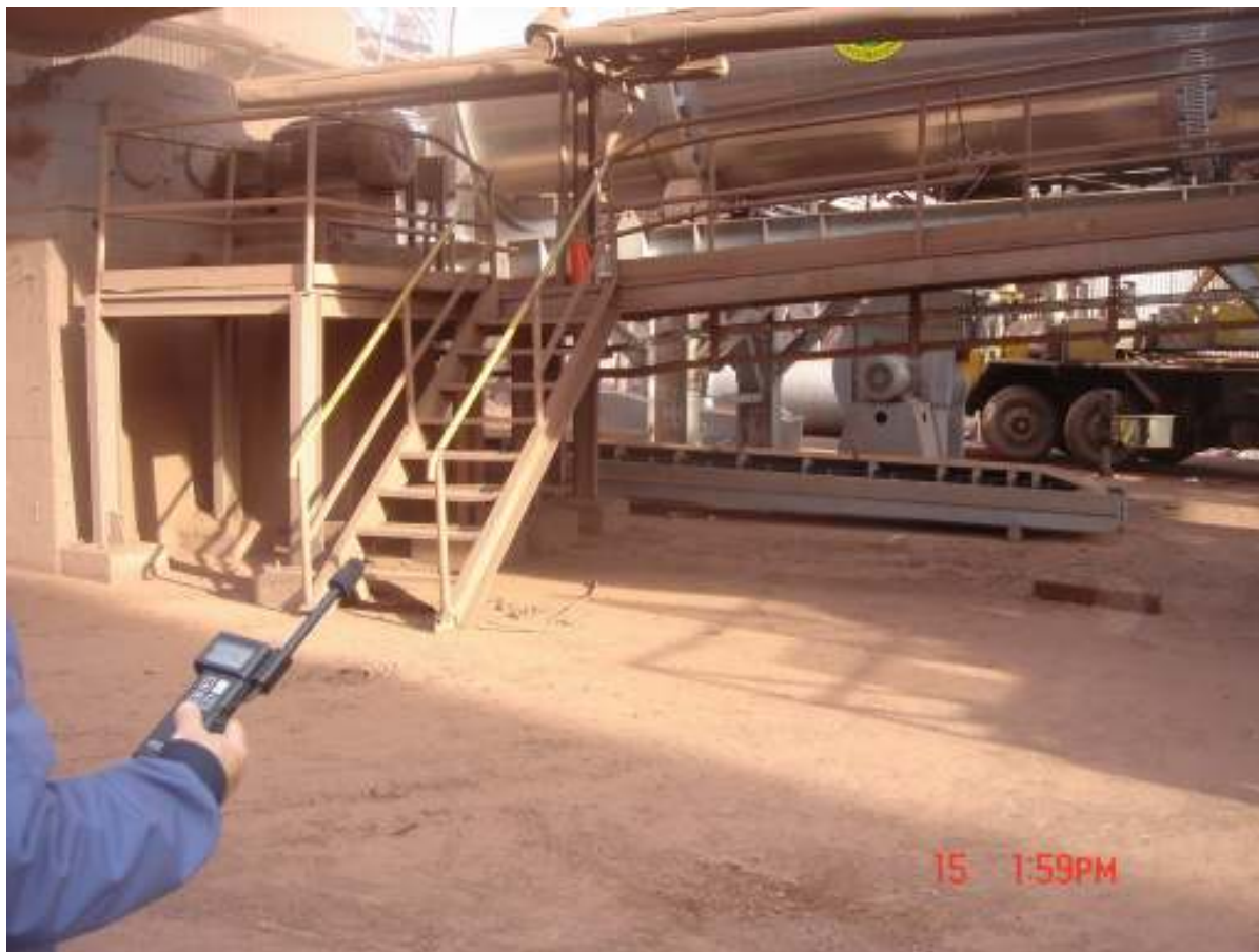
Слика 1 Мерење на вентилатор на вреќасти филтер на дробење
