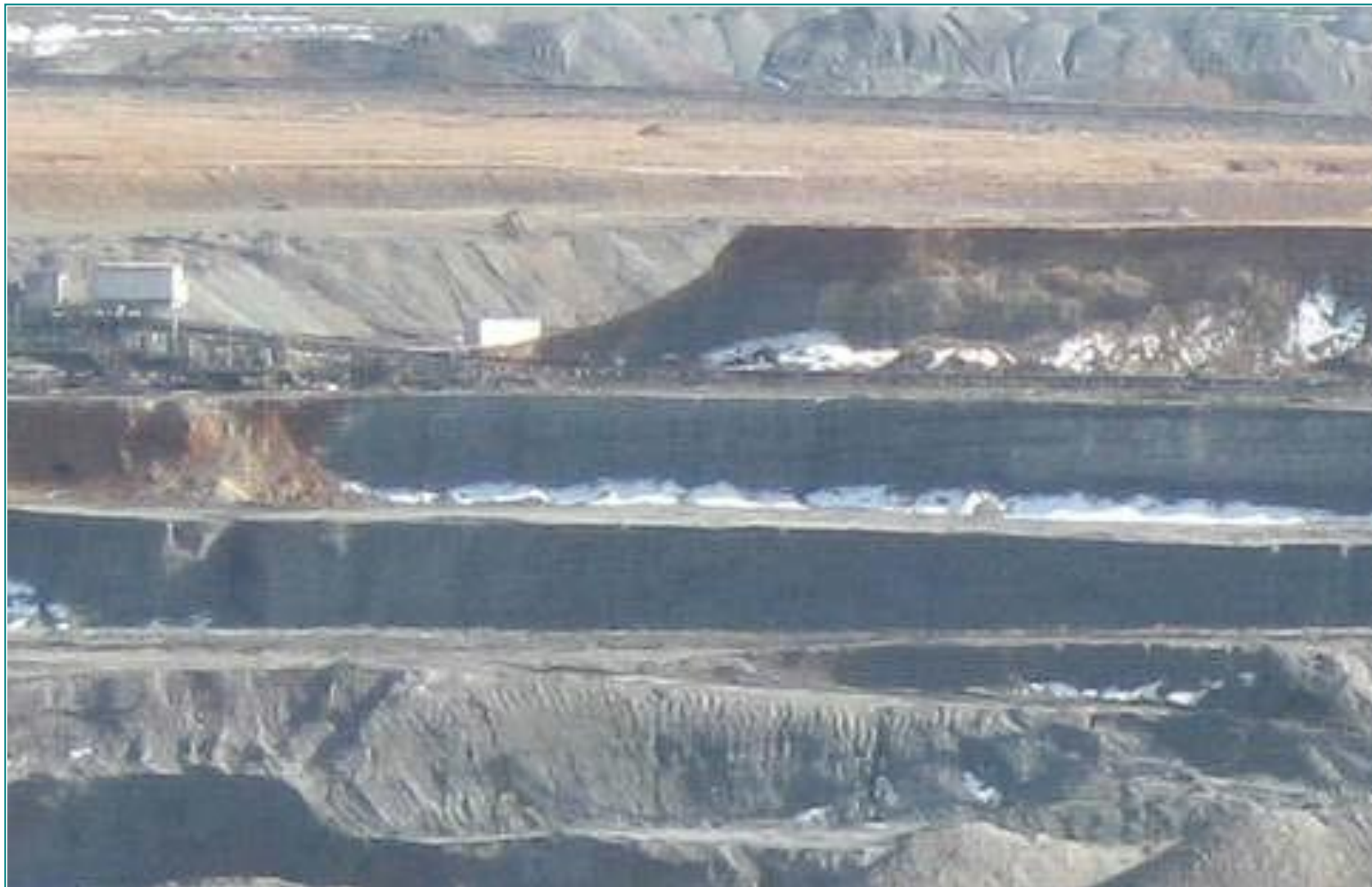
Слика бр. 7: Изглед на етажен ископ
