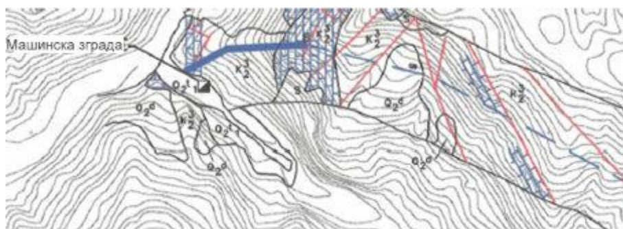
Слика 7-15 Локација на машинската зграда (Paul Rizzo 2002) со слоеви од варовник, во оската на цевководот под притисок кои може да се поврзани со гипс
