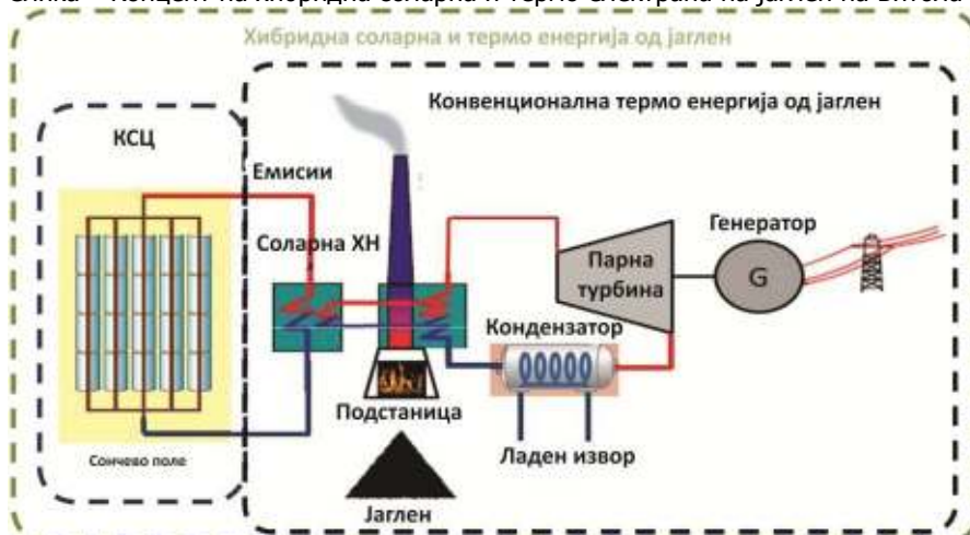
Слика – Концепт на хибридна соларна и термо електрана на јаглен на Битола
