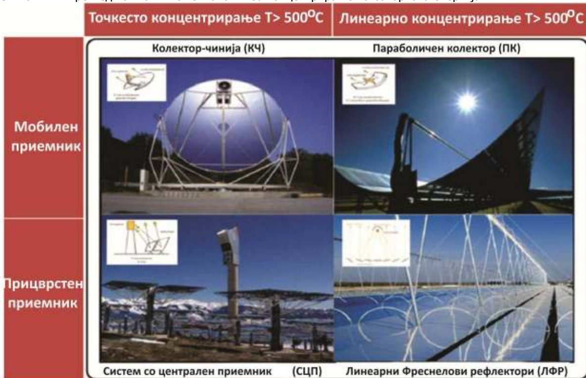
Слика 4-4 – Преглед на главните технологии за концентрирање на соларната енергија
