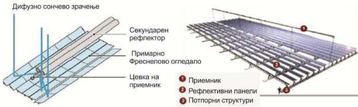
Слика 0-2 – Линеарни Фреснелови колектори
