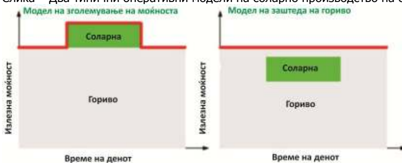
Слика – Два типични оперативни модели на соларно производство на енергија
