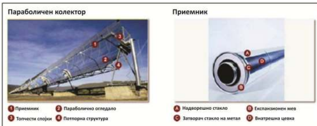
Слика – Елементи на параболичен колектор
