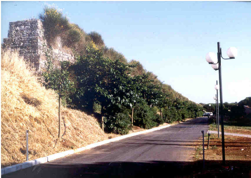
Фото.7 Зид за заштита од бучавата - во комбинација со вегетација
