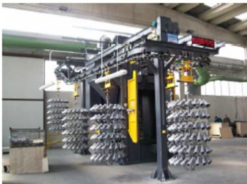
Слика 2-18. Висечка машина за пескарење (Фаза 1)
