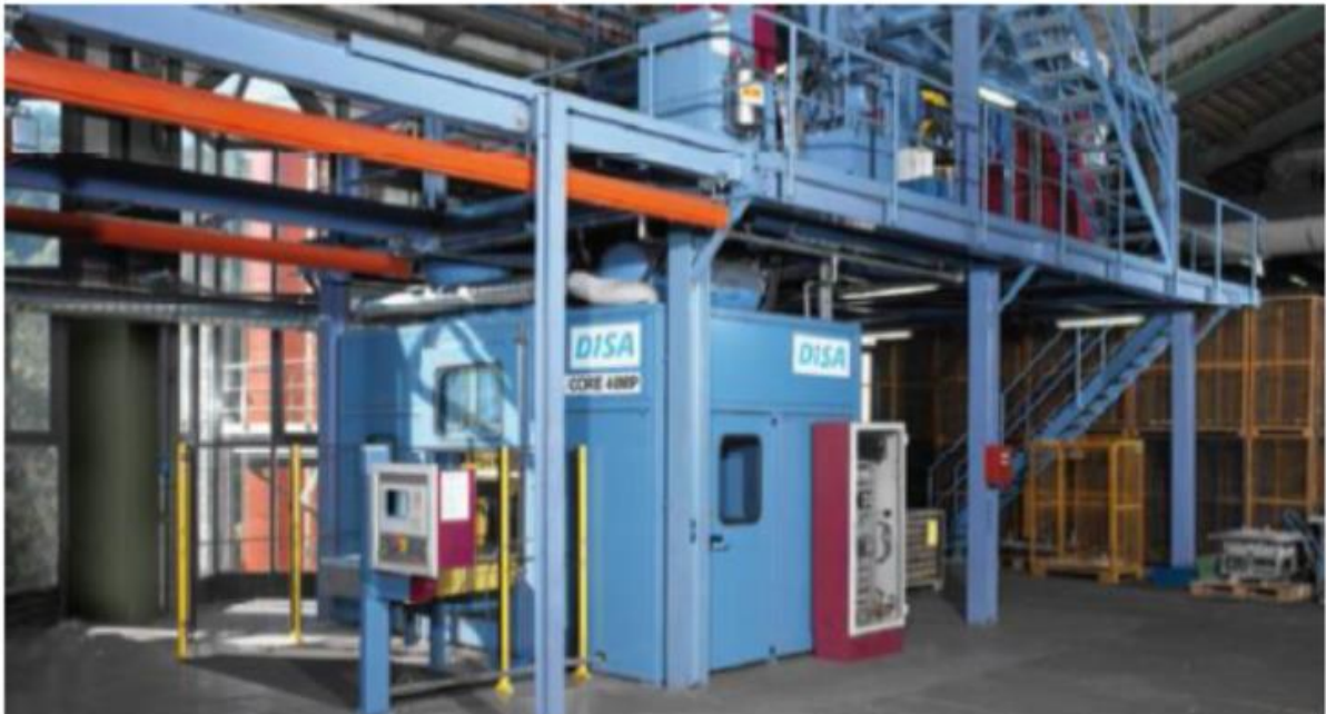
Слика 2-17. Пример за машина за изработка на јадра со припрема на песокот над неа
