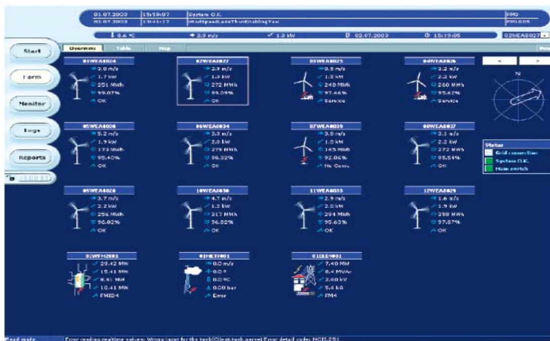
Слика 24 Процес на набљудување на ветерниот парк, од каде може да се види статусот на секоја ветерна електрана поединечно
