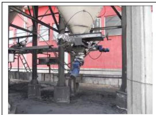
Слика бр. 8 и 9: Систем за транспорт на петро-кокс до печка
