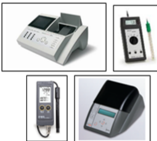
Слика бр. 4/7: Инструмент Spectrophotometer PHARO 300, pH метар - HANNA HI8014, Conductivitymeter - HANNA HI9930 и El thermoreactor TR 620 - MERCK
