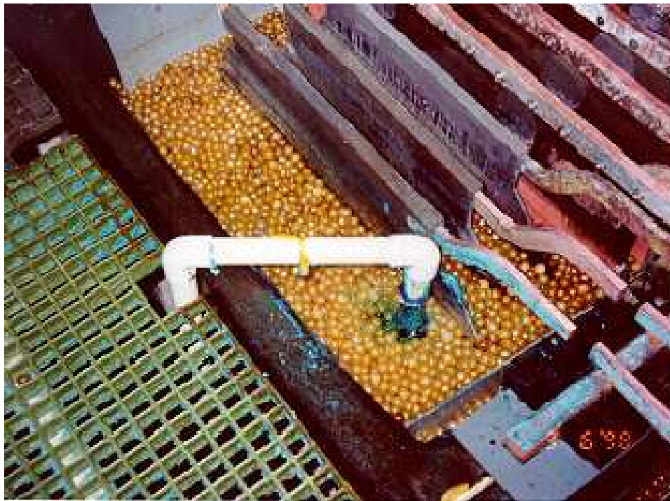
Слика - Топчиња како начин на контрола на емисии
