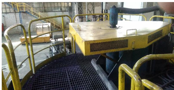
Б) Флотациска ќелија во погон флотација
