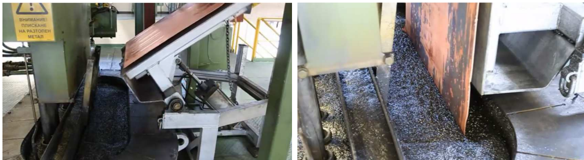
Слика 3 Процес на “хранење” на печка (влез на катоден бакар)
