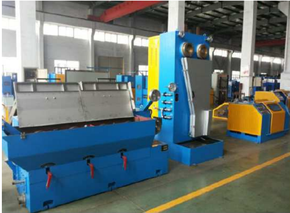
Слика 6 Опрема за влечење и формирање на бакарна жица
