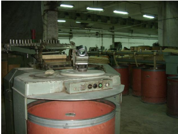
Слика 14 и 15 Чешлање на волната и добивање на волнен топс
