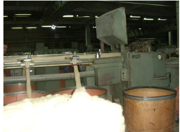
Слика 14 и 15 Чешлање на волната и добивање на волнен топс
