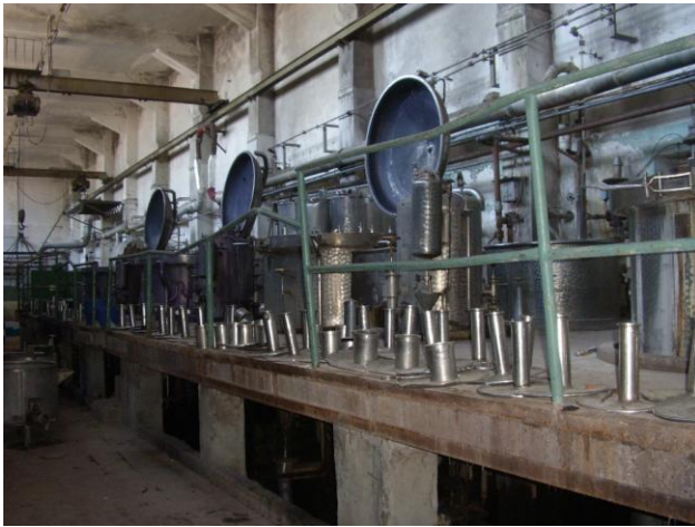
Слика 6 и 7 НТ апарати за фарбање на волна и аклика
