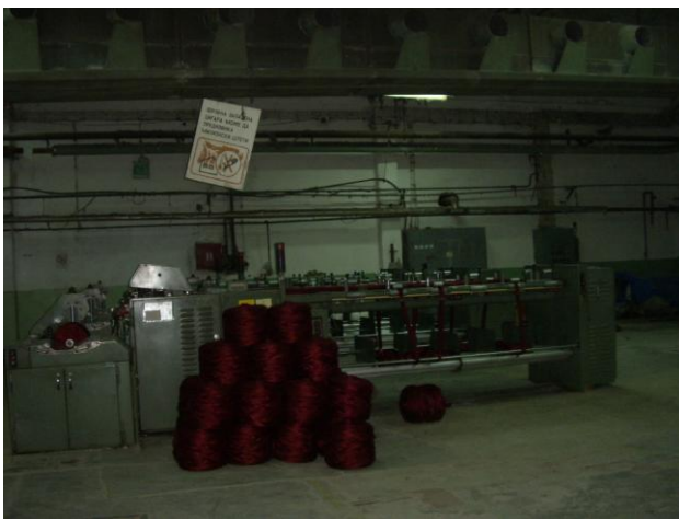
Слика 12 и 13 Омектата трака и фарбан полупроизвод - топс
