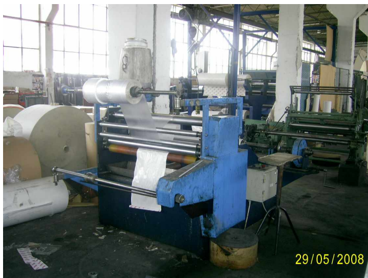
Sl i ka br. 24 Ma{ i nata za pl asti f i ci rawe
