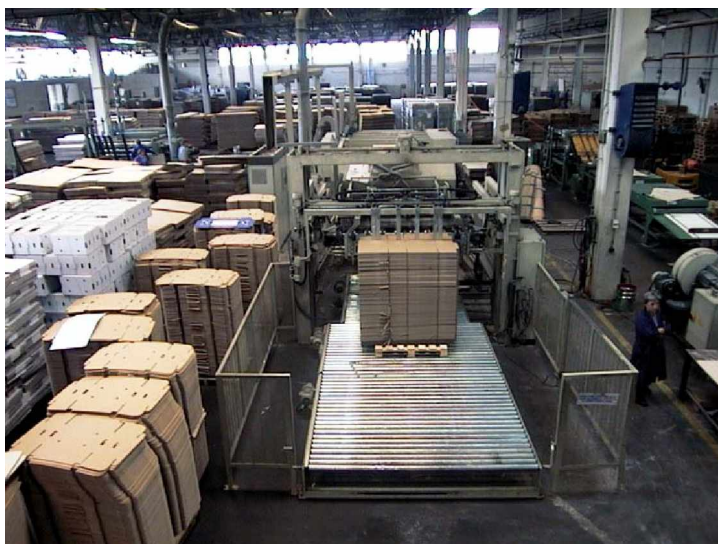
SI i ka br. 7 Avtomatski i zl eguva~ i pal eti zaci ja na Kuri oni
