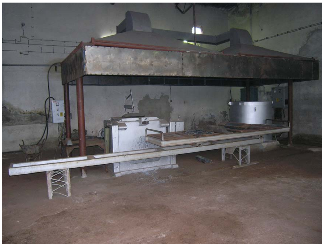
Сл. бр. 6 Електро печки за претопување на олово, алуминиум и цинк
