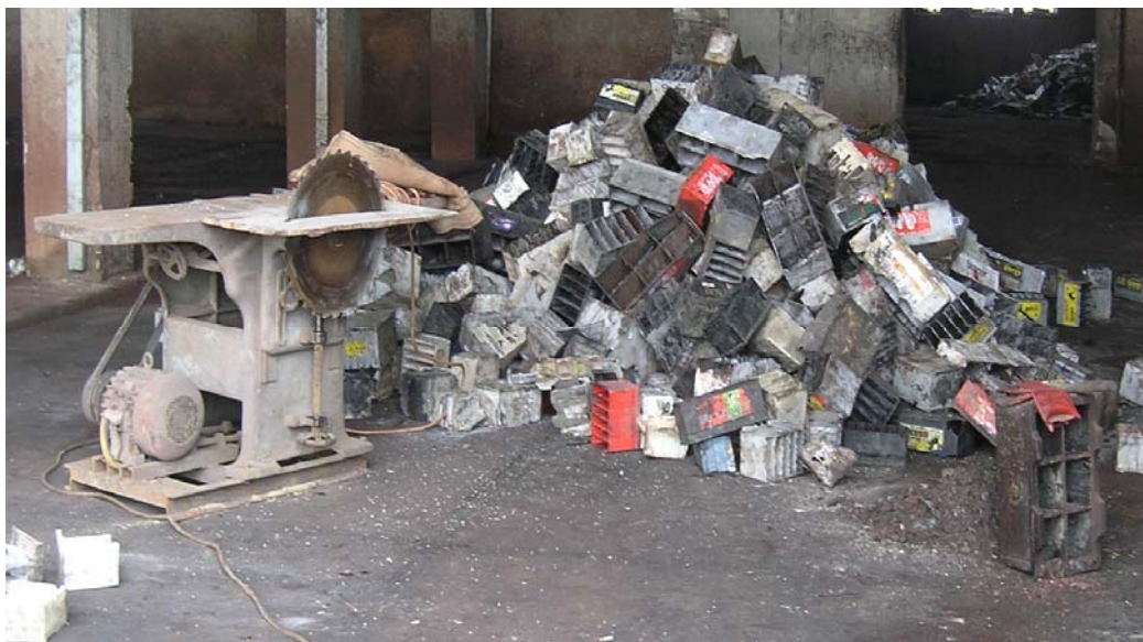
Сл. бр. 3 Циркуларна пила за сечење на акумулаторските кутии
