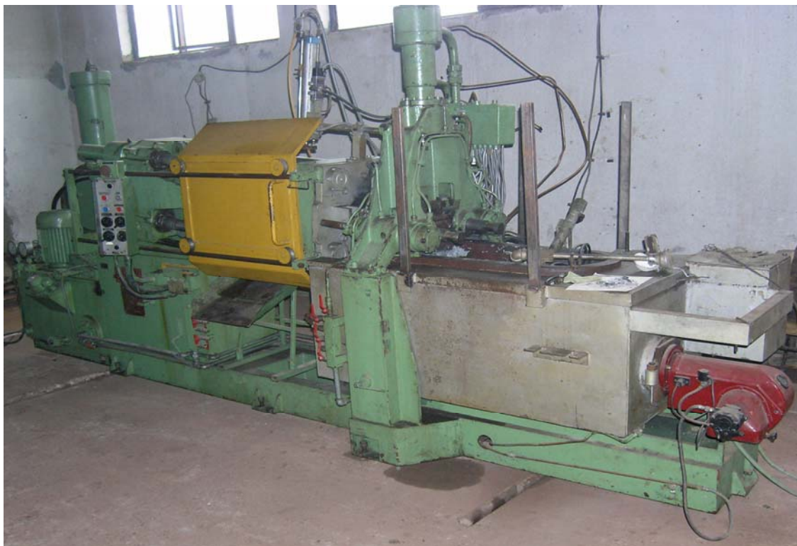
Сл. бр. 5 Машина за изработка на клеми за акумулатори
