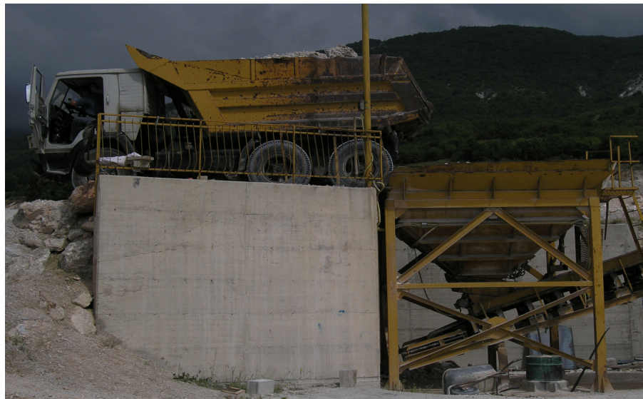
Слика 8. Истовар на минерална суровина во приемен бункер
