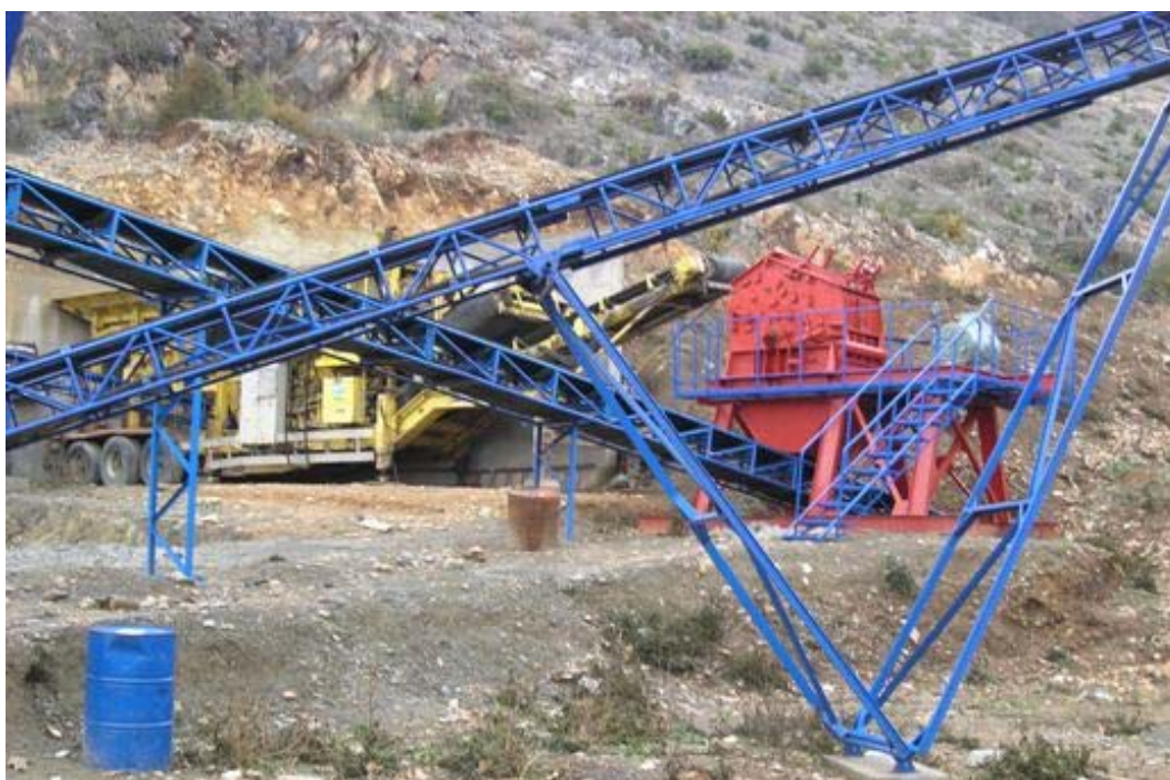
Слика 7. Опремата за дробење и транспорт на Сепарацијата
