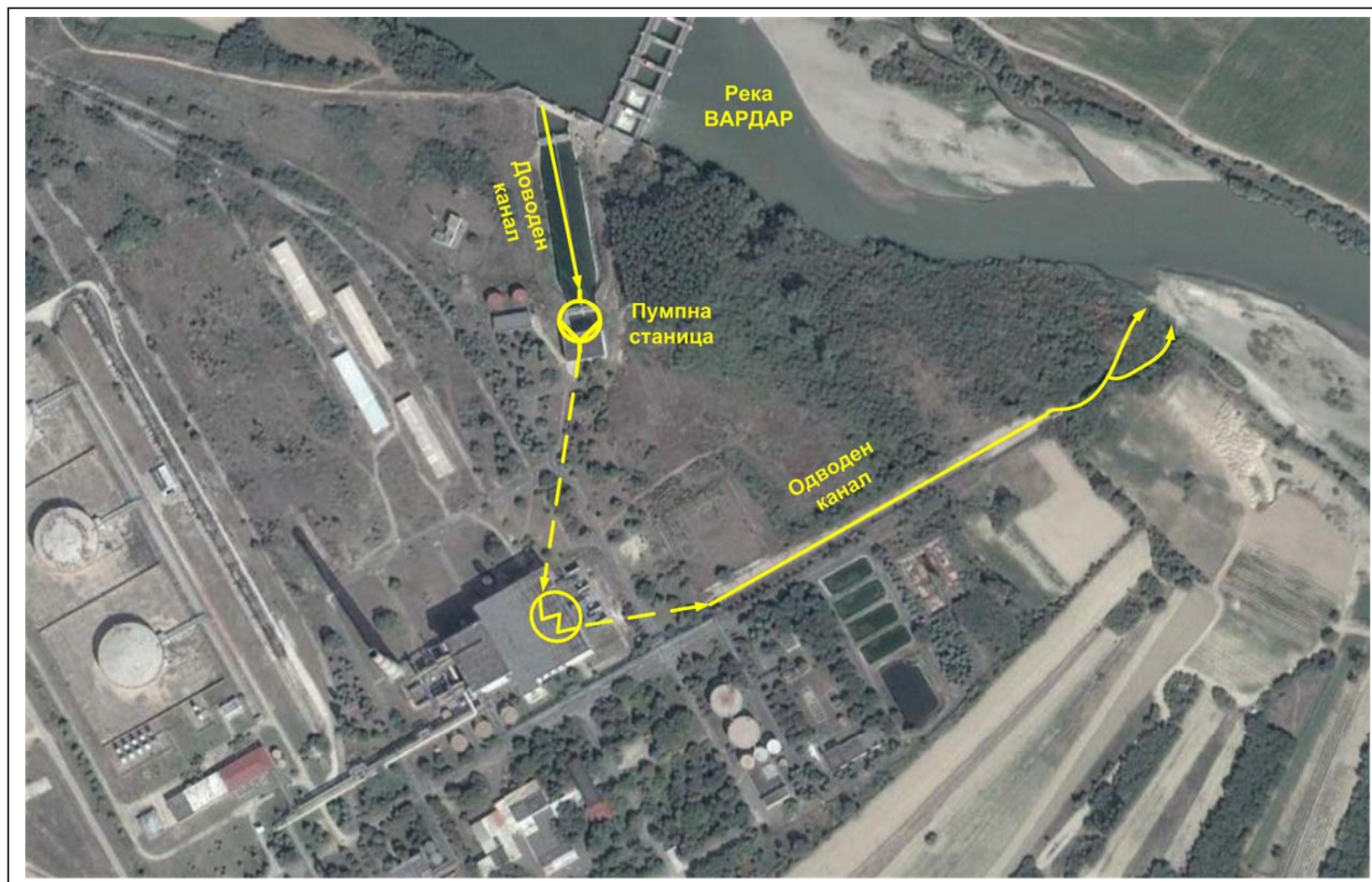
Слика бр. П-3 : Шематски приказ на системот за ладење во ТЕЦ Неготино
