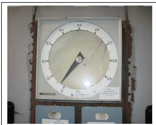
Слики бр. VIII-3 и бр. VIII-4 : Инструменти за мерење на % на H 2 и O 2
