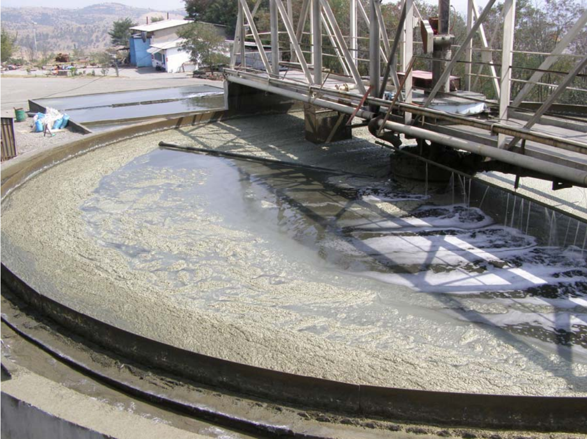
Слика 2.4.2 Поглед на еден од згуснувачите за концентрат. Пената се разбива со млаз вода, цврстите честички концентрат се упатуваат кон дното, а преливната вода поминува преку серија од три таложници кои се гледаат во позадината на сликата.
