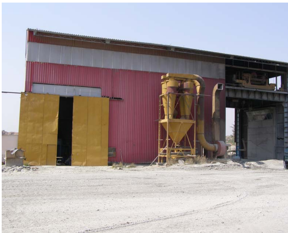
Сл. 8.2.1.1 Батерија циклони за отпрашување на примарното дробење
