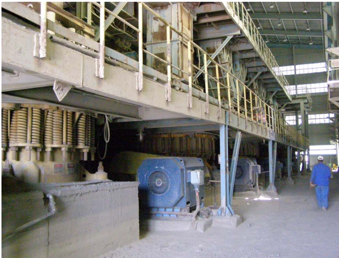
Слика 2.3.1 Поглед на приземјето на халата за секундарно и терцијано дробење. (Во предниот дел е фундамент на една од Симонс дробилките со амортизационите федери и високонапонскиот мотор за погон)
