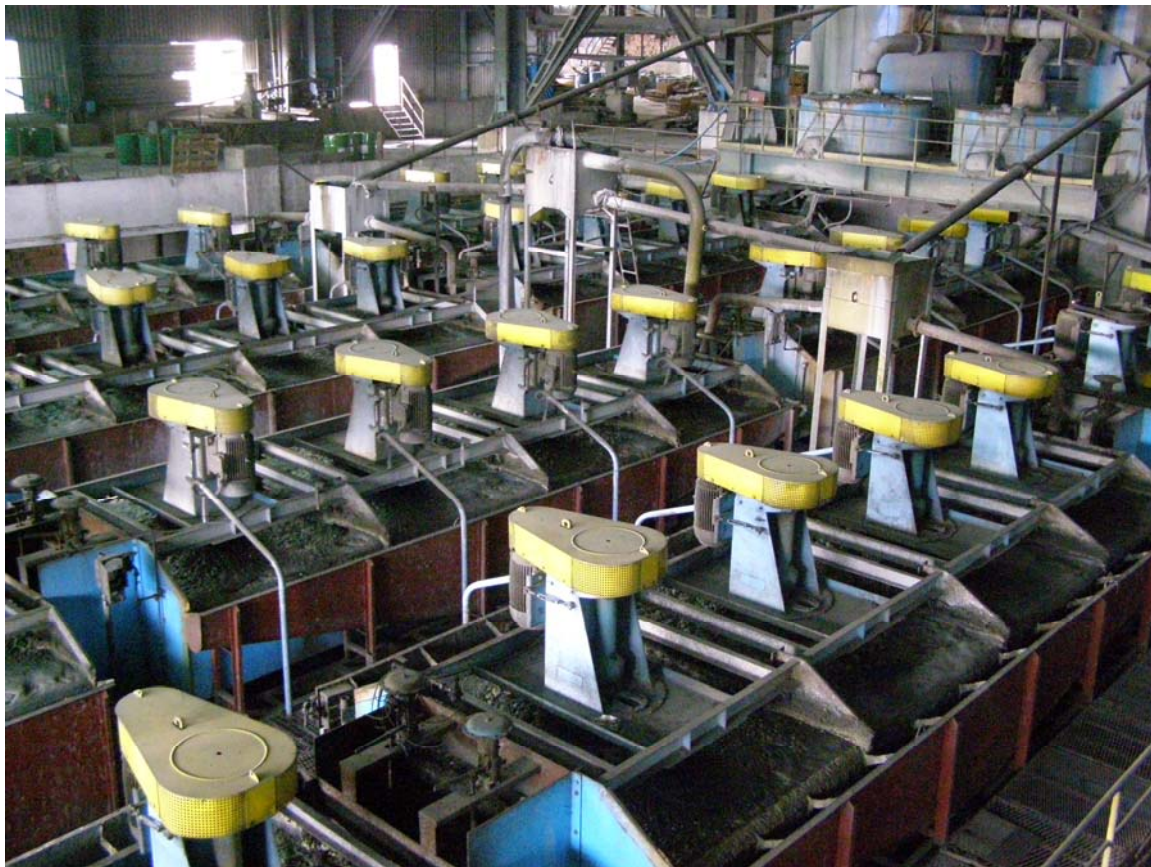
Слика 2.4.1 Поглед на дел од погонот за флотација
