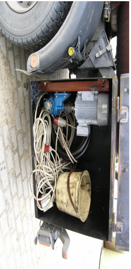
Слика. 6 Опрема за преточување на отпадно масло од клиент до автоцистерна
