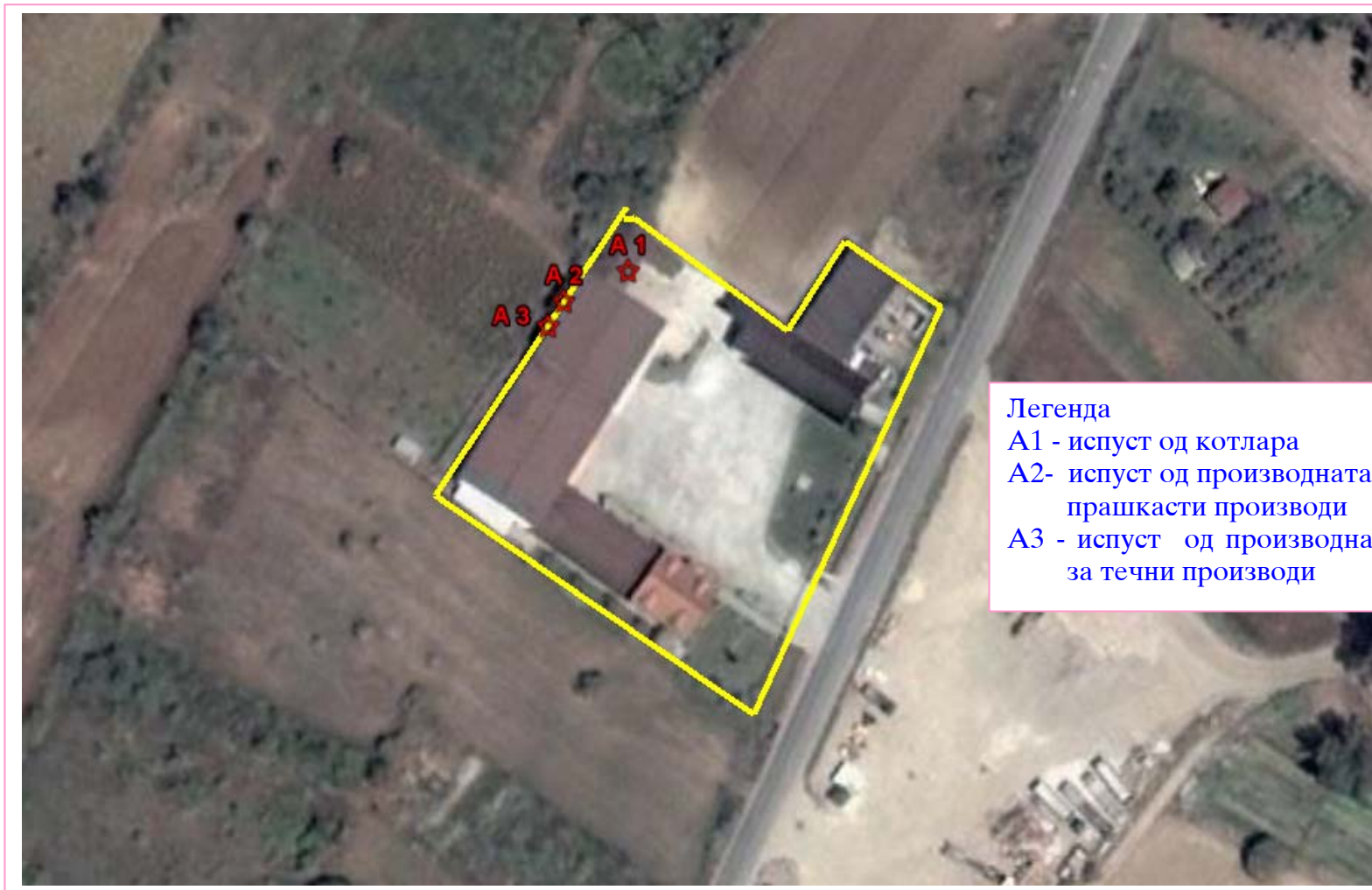
Слика бр.11:Ситуација на инсталацијата со прикажан распоред на мерните места на емисии во воздух (означено со A1 до A3)
