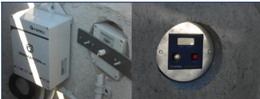
Слика 14 Пример на уред за идентификација поставен за неколку земјоделци. Лево изглед од внатрешна страна. Десно изглед од страната на која ќе пристапуваат корисниците
