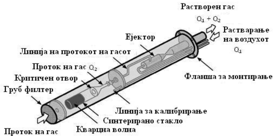
Слика16. Сонда за раствор (извор Фински прирачник за мерење на емисији)
